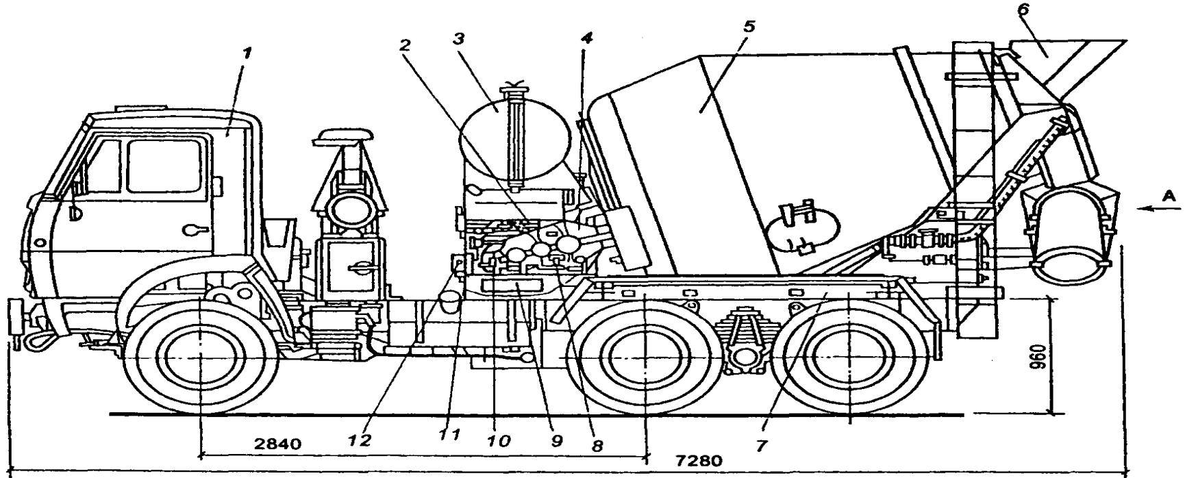
Автобетоносмеситель СБ-92-1А: 1 — насосы КамАЗ-5511; 2 — управление компрессором; 3 — бак для воды; 4 — привод смесительного барабана; 5 — смесительный барабан; 6 — загрузочно-разгрузочное устройство; 7 — рама; 8 — управление реверсом редуктора; 9 — панель контрольно-измерительных приборов; 10 — муфта сцепления; 11 — муфта насоса; 12 — управление подачей топлива.
