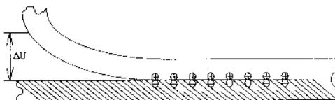
Рис. 15.1. Схема электризации материалов при их разделении
