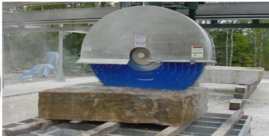
Резка камня с помощью медного диска и масляно-абразивной суспензии
