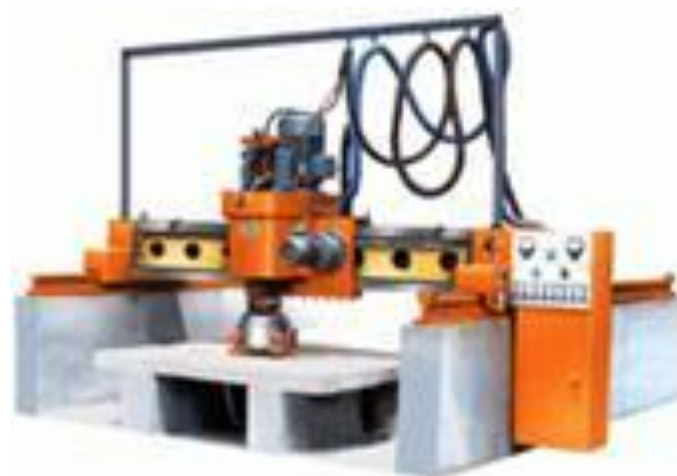
Мостовой одноголовочный шлифовально-полировальный станок
