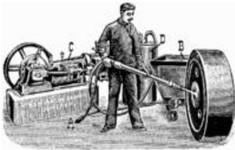
Резка камня с помощью медного диска и масляно-абразивной суспензии
