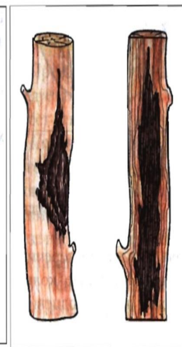
Рис. 98. Пороки древесины: а – рак, б – гниль
