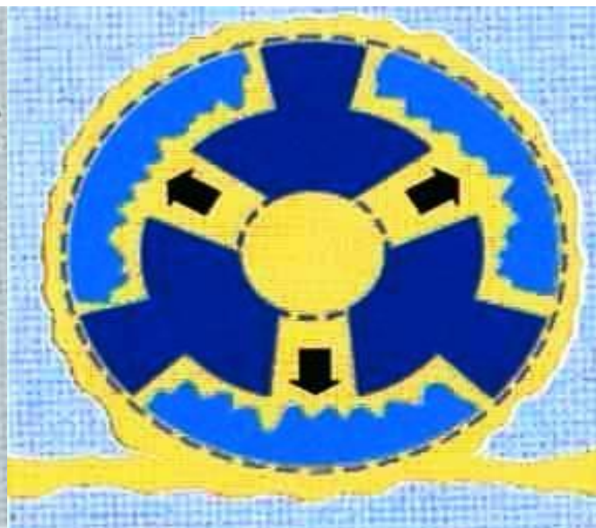
ПОД ДАВЛЕНИЕМ СМОЛЫ КЛАПАНЫ ОТКРЫВАЮТСЯ
