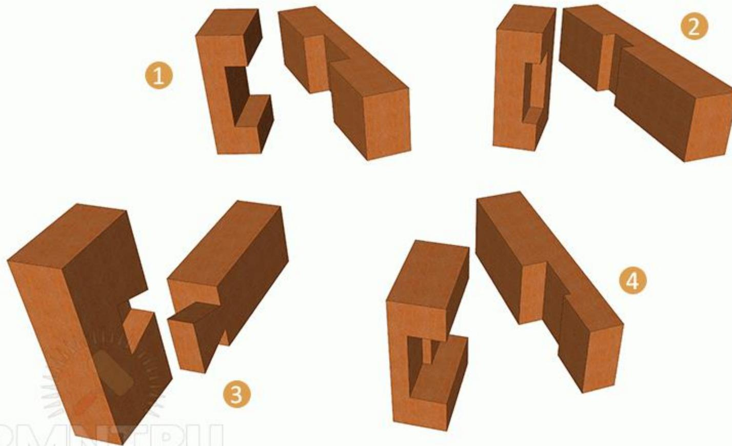
Накладные крестовые и Т-образные соединения используют, как правило, для дополнительных связей между ответственными деталями конструкции. Основная нагрузка в них – на сжатие, смещение и разрыв. Первые два типа нагрузки устраняются подрубкой в полдерева или меньше с последующим совмещением деталей. Плечи зарубок принимают основную нагрузку на себя, остается лишь закрепить соединение шурупами или накладными скобами. В ряде случаев для укрепления связи используют шкант или вырубают шип с клином.
