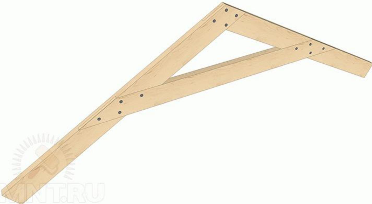
Надрезанные в полдерева торцы можно свести практически под любым углом, это основной метод соединения кровельных ферм. Для скрепления деталей необходима дополнительная стягивающая связь: брус прикладывают к соединенным деталям сбоку на расстоянии в 30-50 см от угла и подрубают в половину толщины по местам соприкосновения, а затем скрепляют конструкцию гвоздями.
