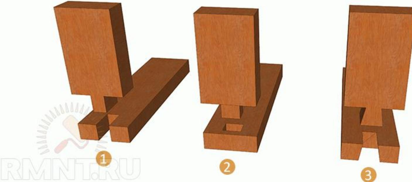
Угловые соединения: 1 – с открытым сквозным шипом; 2 – с глухим закрытым шипом; 3 – со сквозным косым шипом
