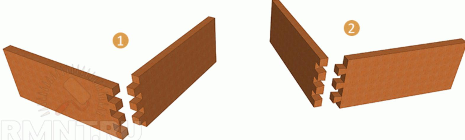
Отдельный тип соединений – ящичные. Предназначены они для соединения досок под прямым углом. Обычно для ящичного соединения на каждой доске нарезают зубья, ширина которых равна расстоянию между ними. На разных досках зубья нарезаны со смещением, поэтому при соединении угол из досок выглядит как одно целое. Зубья также могут иметь клиновидную форму, препятствующую разрыву угла в одном направлении, либо скрепляются дополнительно kleem или гвоздями.
