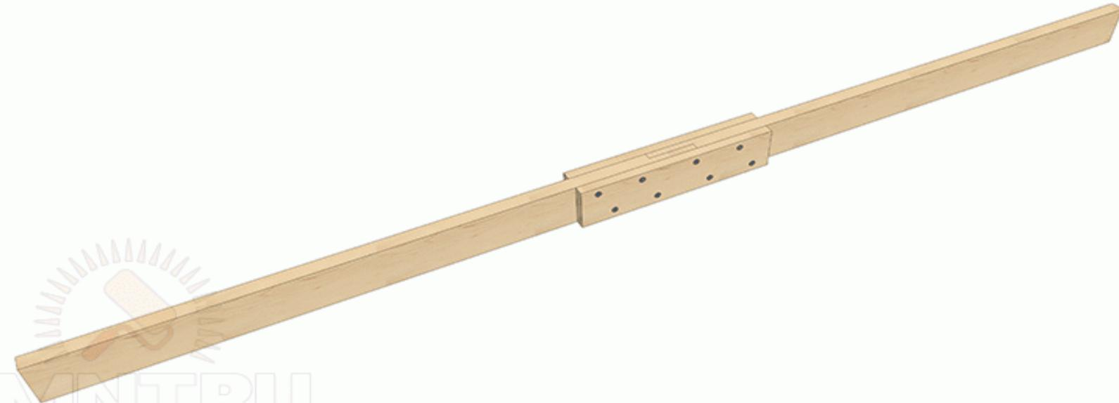
Для несущих конструкций используют два вида соединений – наращивание и сочленение. Самый простой способ срастить две детали – выполнить надрез ножовкой на половину толщины на одинаковом расстоянии от торцов, а затем сколоть топором лишнюю древесину. После сопоставления двух деталей соединение обычно скрепляют двумя накладными планками, прибитыми сбоку от разреза. Склейивание тоже возможно, но только при плотной подгонке деталей.
