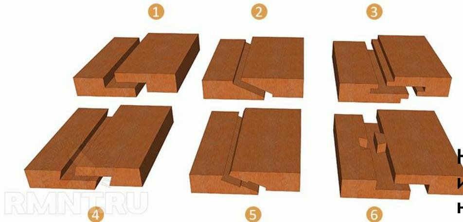
Наиболее просты торцевые соединения, их применяют при необходимости нарастить деталь. Лучше всего такие соединения переносят нагрузку сжатия, однако при вырубке замков специальной формы можно достичь хорошего сопротивления скручиванию, растяжению и изгибу.
