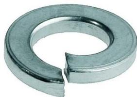
**Пружинная шайба** — разрезная круглая шайба, концы которой расположены в разных плоскостях. Служит для предотвращения самоотвинчивания резьбовых соединений за счет упругой деформации шайбы под нагрузкой.
