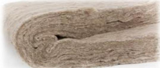
**Древесное волокно (целлюлозная вата)** на данный момент считается одним из самых известных органических теплоизоляционных материалов. Представляет собой древесный материал, измельченный до состояния ваты. Производится как в сыпучем виде, так и в плитах. Используется для задувания в полости стен.
