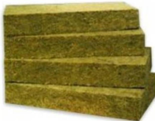
**Каменная вата** производится из горной породы диабаза путем расплавления и превращения жидкой массы в волокна. Такой материал на 99 % состоит из воздуха и только на 1 % из горной породы. Используется для утепления стен и других конструкций повсеместно.
