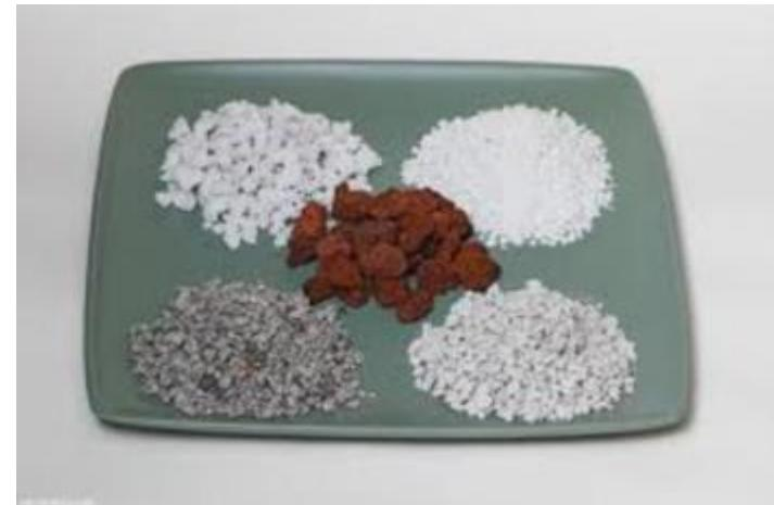
**Перлит** – вулканическая порода. При нагревании увеличивается в несколько раз, из-за чего процесс производства напоминает создание попкорна. Используется для теплоизоляции с середины прошлого века.
