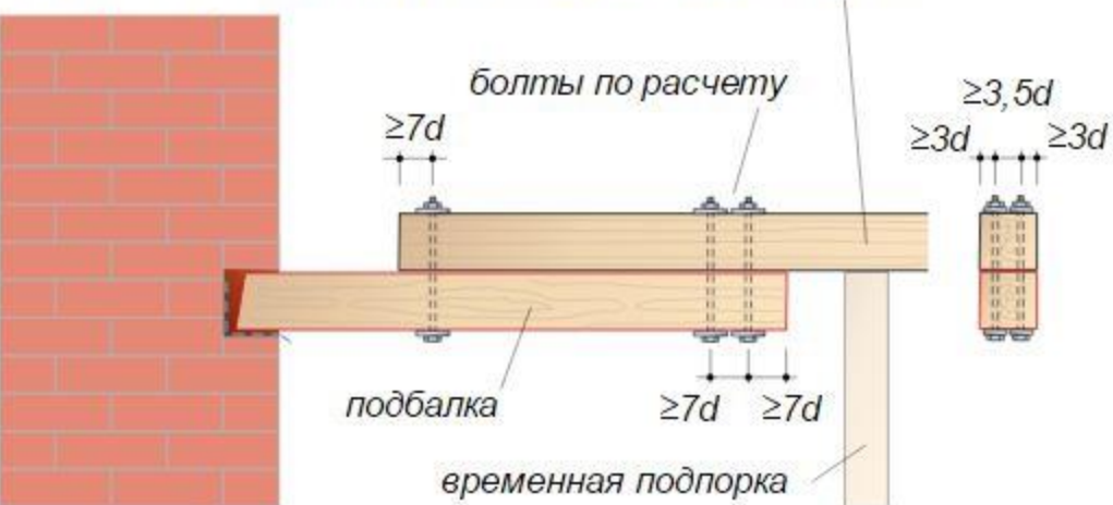
усиливаемая балка с отпиленным подгнившим концом
