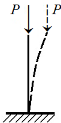
Рис. 9.1. Схема потери устойчивости стержнем
