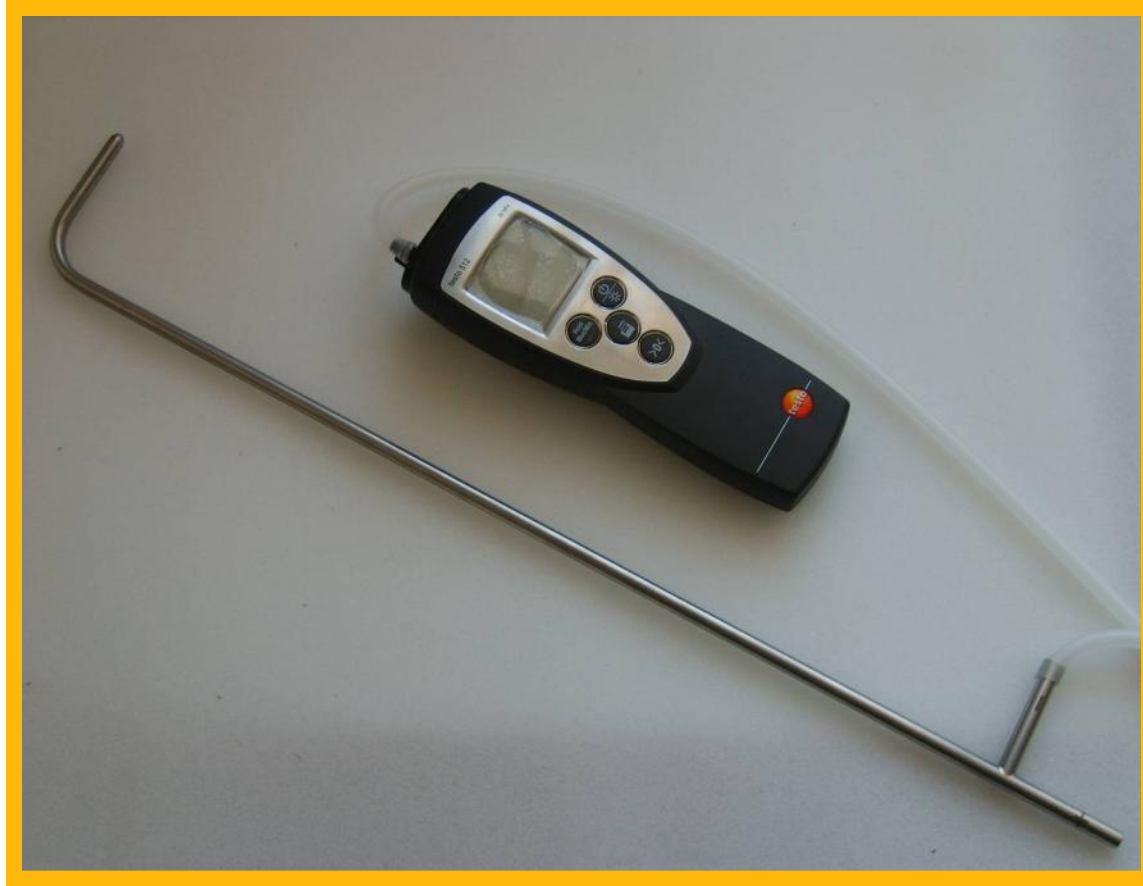
Прибор Testo-512 с приемником статического давления
