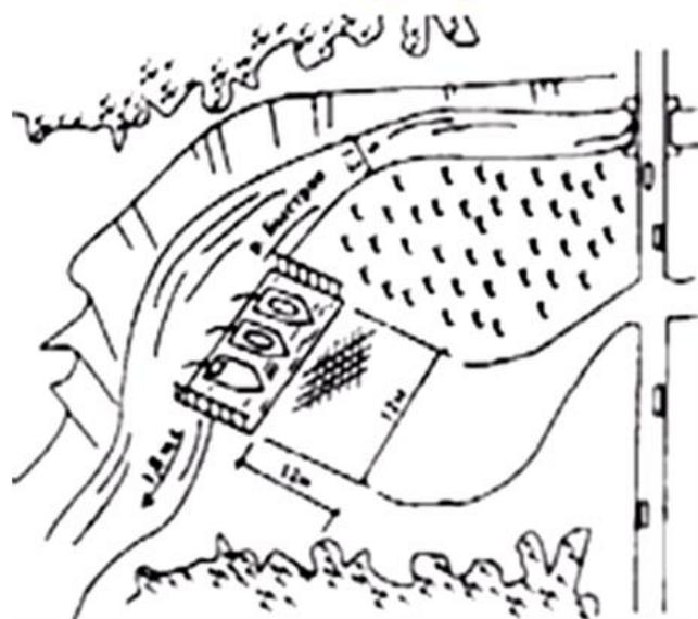
К пожарным водоемам делают благоустроенные тупиковые дороги с петлевыми объездами у водоисточника или площадками размером **12x12 м** для установки пожарных машин и их маневрирования
