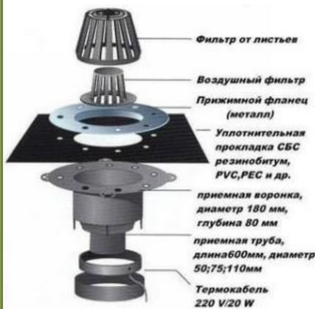
Устройство водосточной трубы с воронкой под водосток
