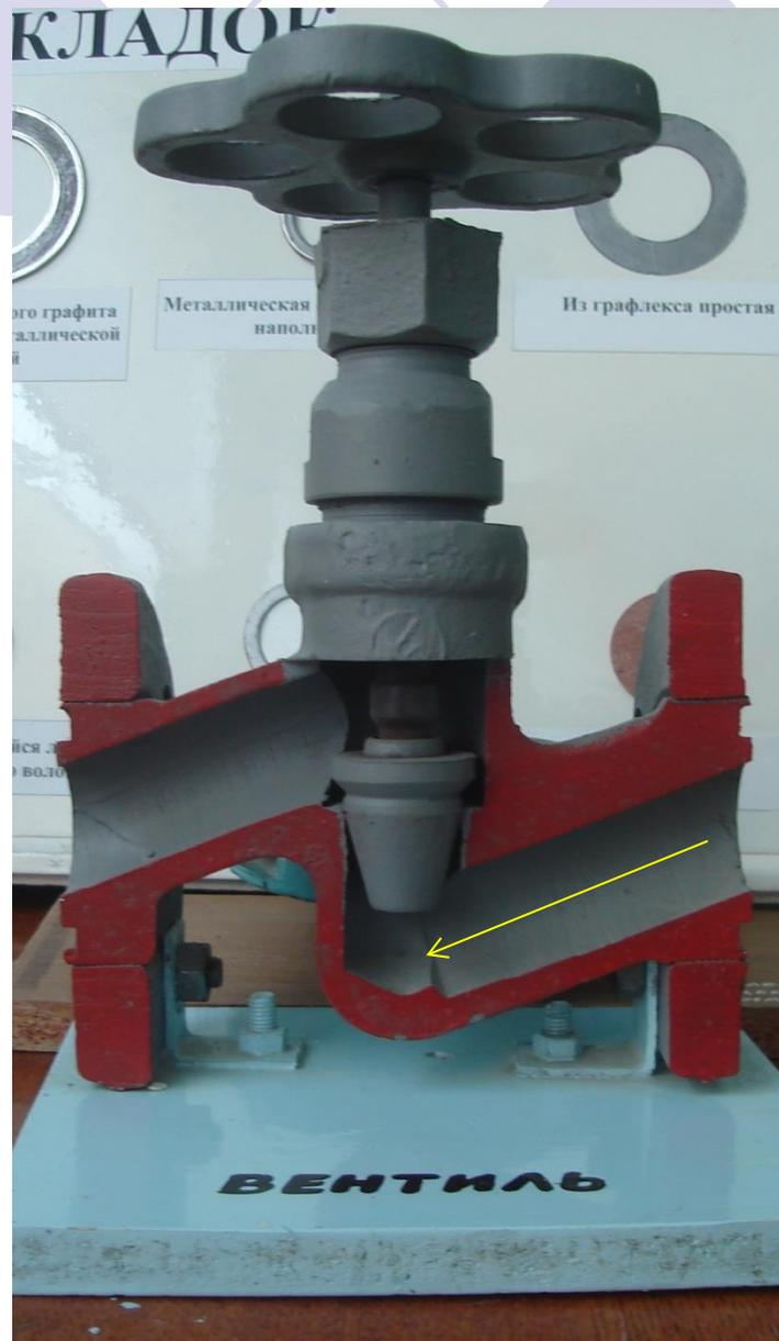
**Нормальный вентиль** имеет бочкообразный корпус 7, в котором перемещается на резьбе шпindel 3; к нижнему концу шпинделя крепится клапан 5. При закрывании вентиля клапан плотно прижимается к седлу 6 корпуса
