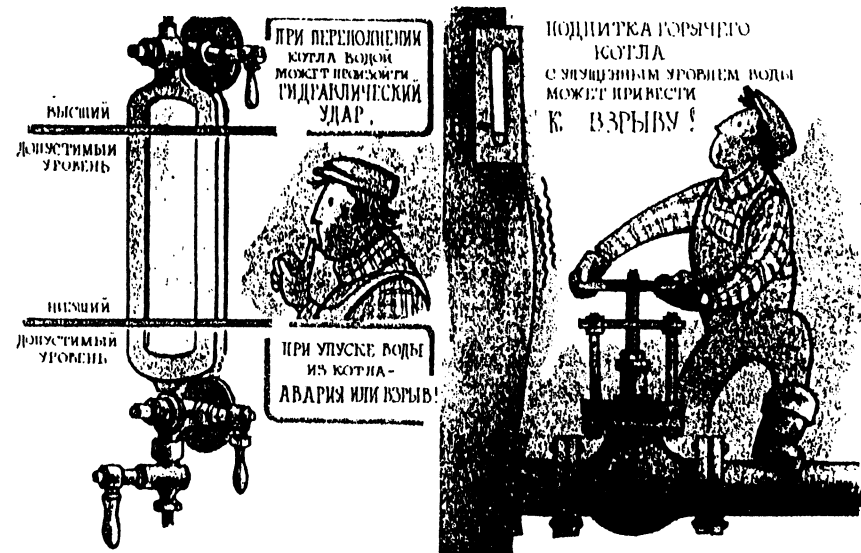
Рис. 62. Причины и последствия упуска воды из котла
