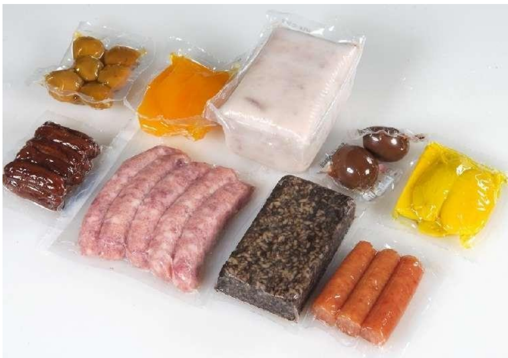
Рис.1.7. Вакуумная упаковка с помощью термоусадочной ленты
