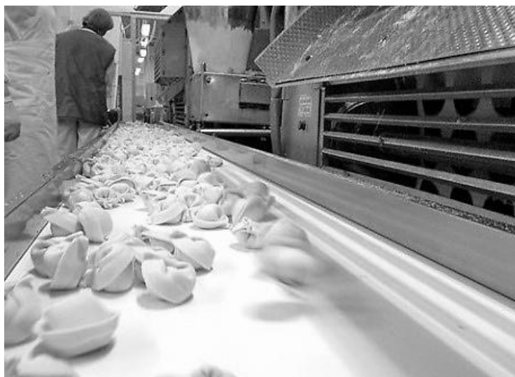
Рис. 2.6. Применение конвейерной ленты с покрытием Butyl
