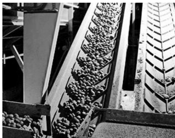
Рис. 2.8. Шевронная конвейерная лента, используемая для транспортирования картофеля
