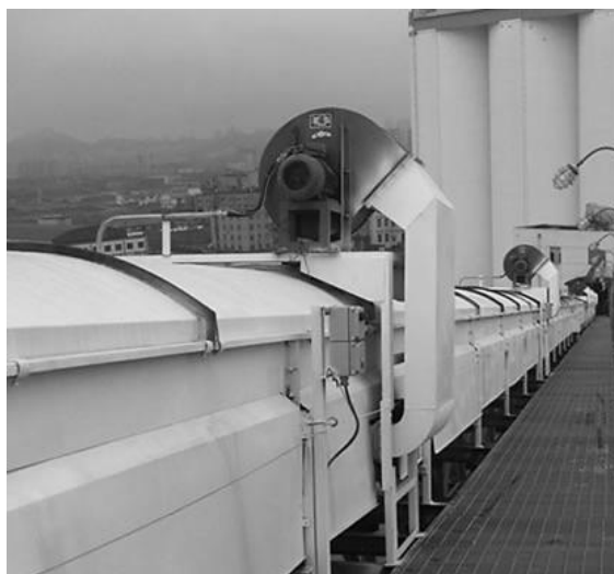
Рис. 1.21. Конвейер ленточный на воздушной подушке (Китай), система погрузки зерна насыпью с производительностью 500 т/ч
