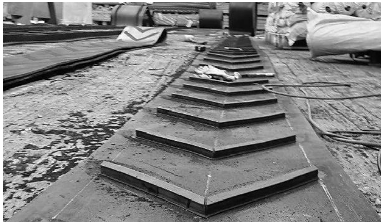
Рис. 2.9. Горячая вулканизация шеврона на ленту GR с тканевым тяговым каркасом (многослойный – число прокладок от 2 до 5) с резиновыми обкладками на основе хлоропренового каучука; разрывная прочность ленты 630-2 500 Н/мм, исполнение – трудногораемое
