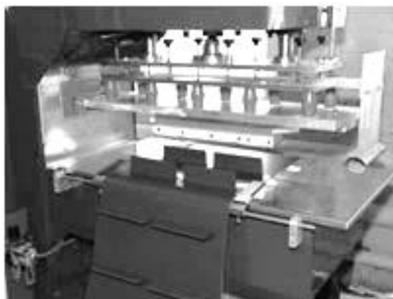
Рис. 2.16. Пресс для сварки захватов на ленту токами высокой частоты
