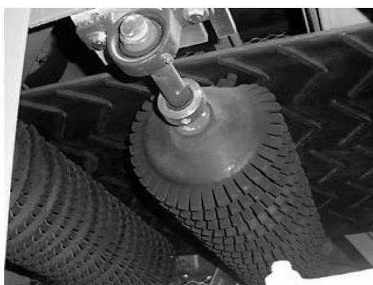
Рис. 5.12. Роликовый очиститель с резиновыми дисками
