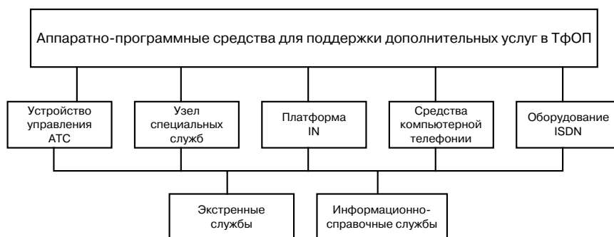
Рис. 7.3. Классификация аппаратно-программных средств для поддержки дополнительных услуг в ТФОП
