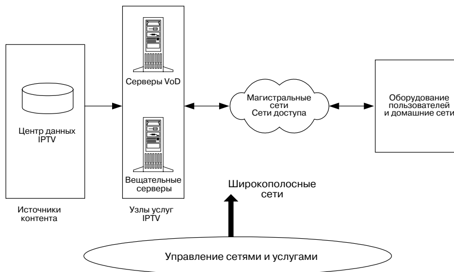
Рис. 26.5. Упрощенная архитектура системы IPTV
