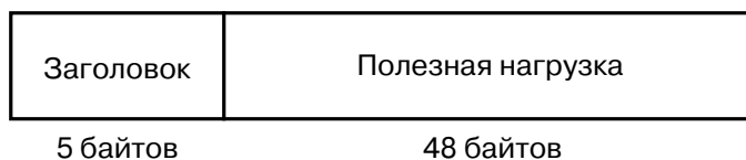
Рис. 22.4. Структура ячейки ATM
