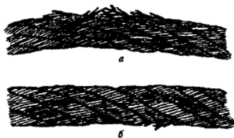
Рисунок 3. Обрывы проволок в зоне уравнильного блока:
