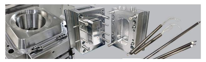
Среднее количество каналов для нагревательных элементов составляет 10-15. Напряжение питания 220 В. Для отслеживания температуры нагрева в корпус плиты устанавливается термопара. Недостатком электрического обогрева плит является перепад температур в пределах 5-15°C на различных участках плиты.
