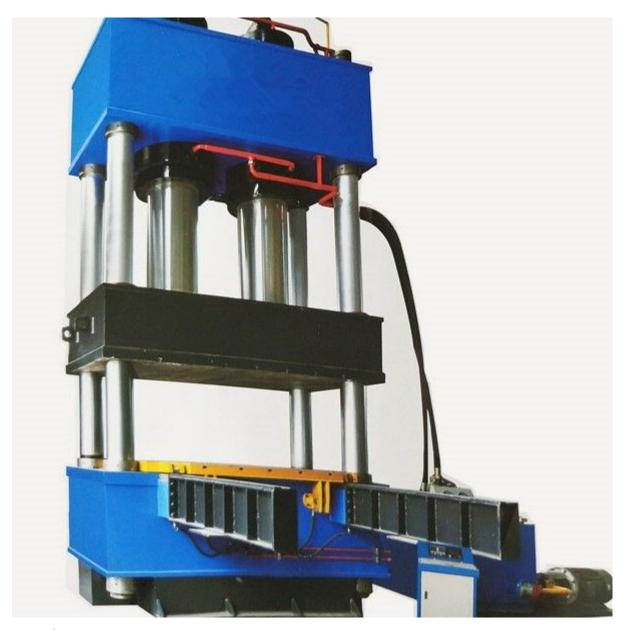
Наибольшей популярностью пользуются модели с четырьмя колоннами. Колонны служат не только элементами станины, но и направляющими, регулирующими ход ползуна в процессе прессования. К их преимуществам относится легкий доступ к пресс-форме и возможность изменения просвета пресса за счет увеличения или уменьшения высоты колонн.
