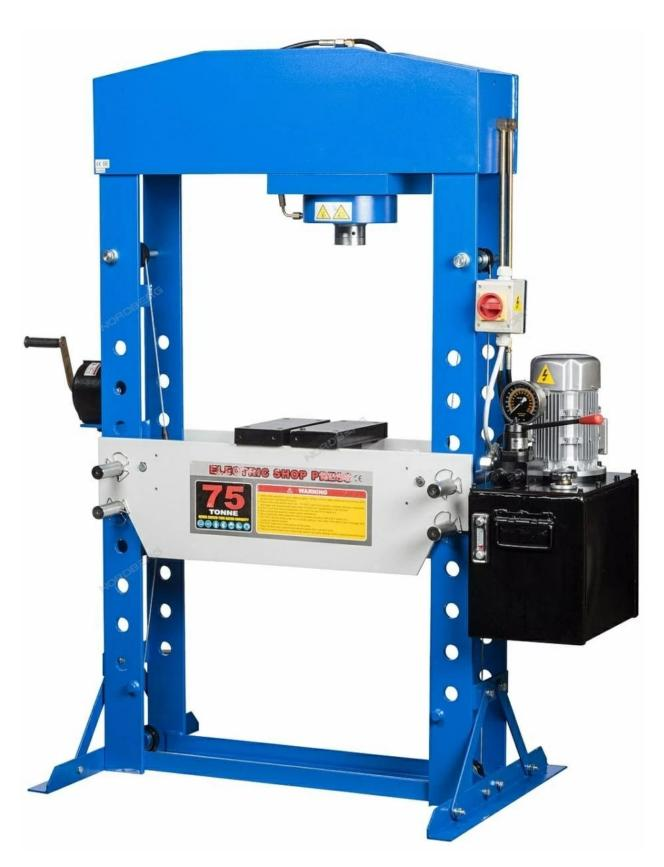
Рамные прессовочные станки имеют простую конструкцию, они менее трудоемки в исполнении и легко комплектуются дополнительным оборудованием. Широко используются для производства резинотехнических изделий.
