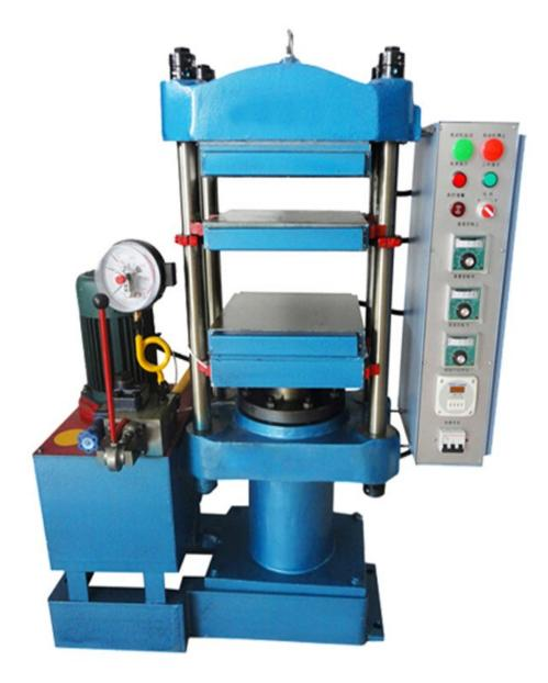
Конструкция этажных прессов предполагает размещение плит параллельно друг другу с небольшим просветом. Толщина плит, приблизительно, 60 мм. В случае парового охлаждения в плитах предусмотрены каналы для подачи горячего пара. Среднее номинальное суммарное усилие этажных прессов составляет 50 МН. Это самые мощные прессы, которые используется в сфере производства изделий из пластика, дерева, металла.
