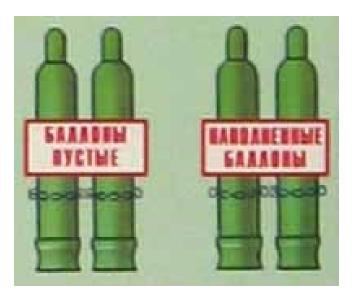
Наполненные и порожние баллоны хранят раздельно, обозначая места хранения соответствующими табличками
