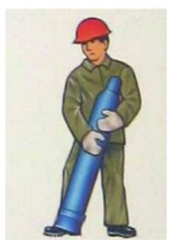
Кантование на башмаке в наклонном положении
