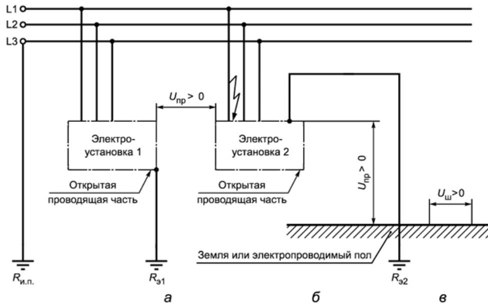
$U_{пр}$  - напряжение прикосновения;  $U_{ш}$  - шаговое напряжение;  $R_{и.п.}$  - заземлитель источника питания;  $R_{з1}$  - сопротивление заземления электроустановки 1;  $R_{з2}$  - сопротивление заземления электроустановки 2
