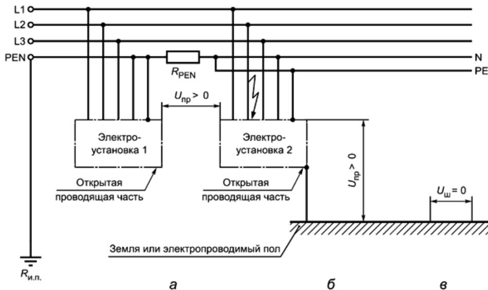
$U_{пр}$  - напряжение прикосновения;  $U_{ш}$  - шаговое напряжение;  $R_{и.п.}$  - заземлитель источника питания;  $R_{ПЕН}$  - полное сопротивление PEN-проводника
