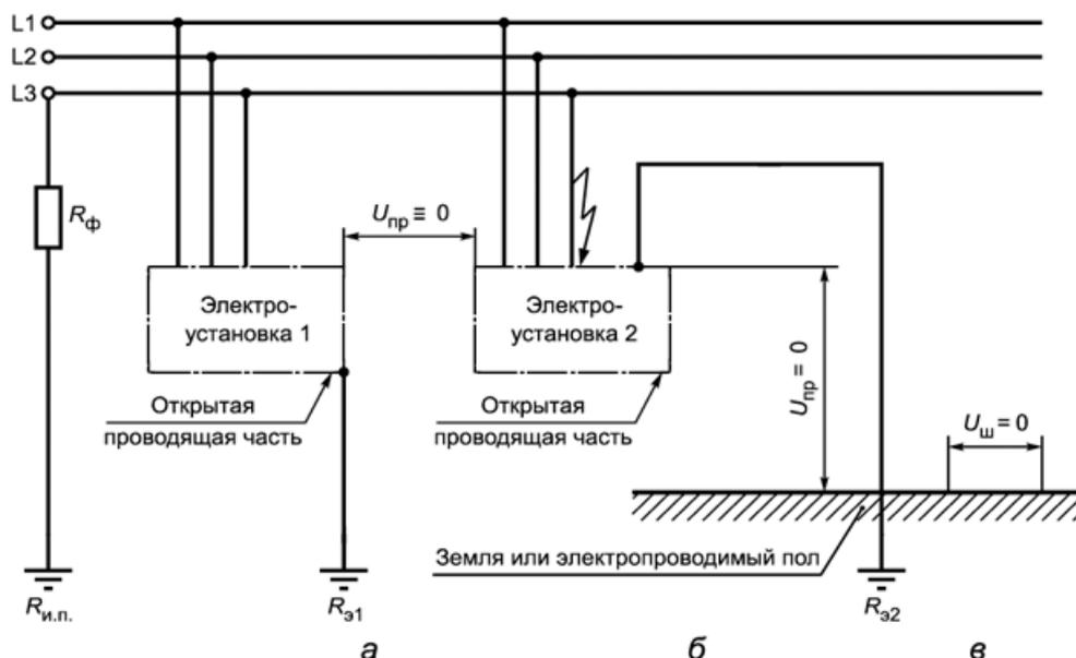
$U_{пр}$  - напряжение прикосновения;  $U_{ш}$  - шаговое напряжение;  $R_{и.п.}$  - заземлитель источника питания;  $R_{э1}$  - сопротивление заземления электроустановки 1;  $R_{э2}$  - сопротивление заземления электроустановки 2;  $R_{\phi}$  - сопротивление в заземляющем проводнике фазы источника питания
