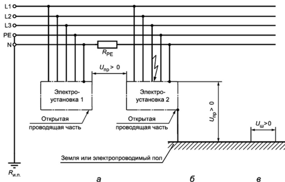
$U_{пр}$  - напряжение прикосновения;  $U_{ш}$  - шаговое напряжение;  $R_{и.п.}$  - заземлитель источника питания;  $R_{PE}$  - сопротивление PE-проводника
