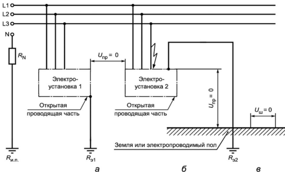
$U_{пр}$  - напряжение прикосновения;  $U_{ш}$  - шаговое напряжение;  $R_{и.п.}$  - заземлитель источника питания;  $R_{з1}$  - сопротивление заземления электроустановки 1;  $R_{з2}$  - сопротивление заземления электроустановки 2;  $R_N$  - сопротивление в заземляющем проводнике нейтрали источника питания
