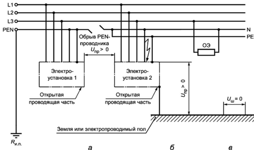
$U_{пр}$  - напряжение прикосновения;  $U_{ш}$  - шаговое напряжение;  $R_{и.п.}$  - заземлитель источника питания; ОЭ - однофазный электроприемник
