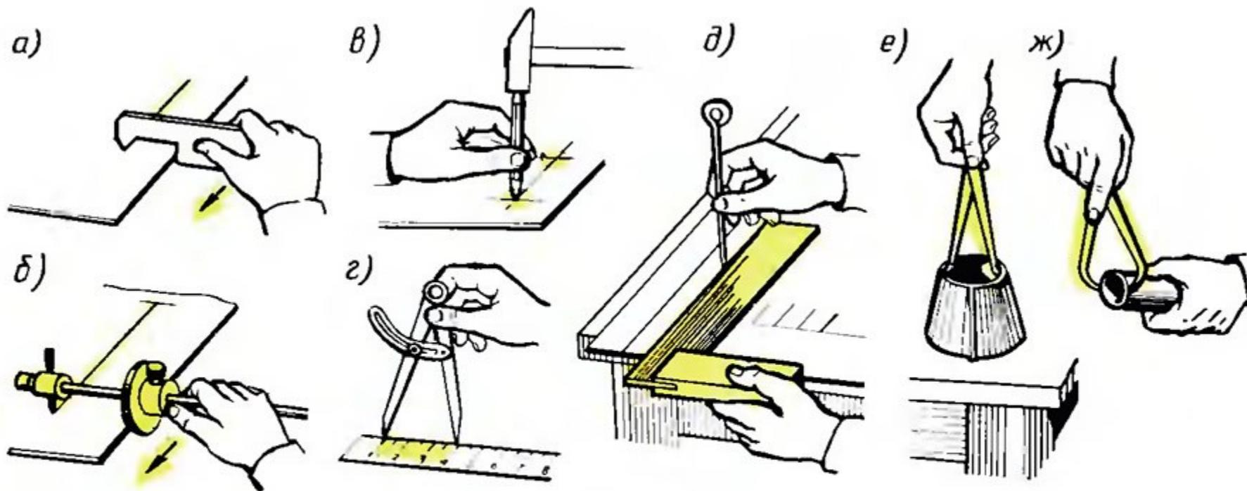
Рис. 106. Приемы разметки:
