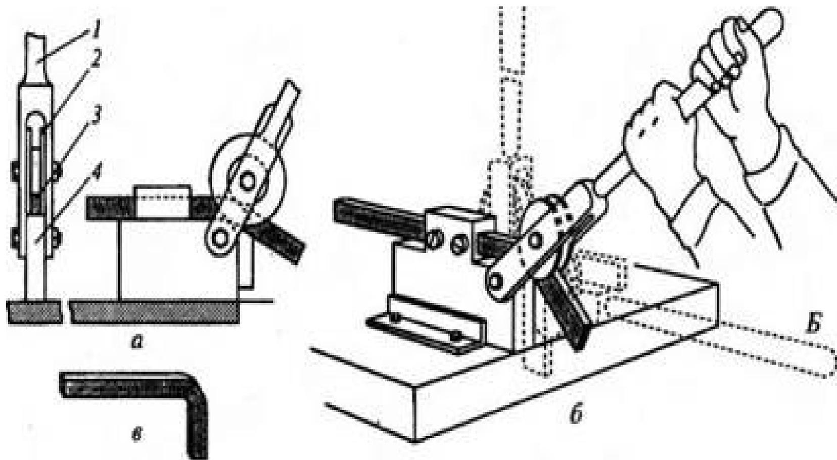
Рис. 2.47. Приспособление для гибки рамки ножовочного станка:
